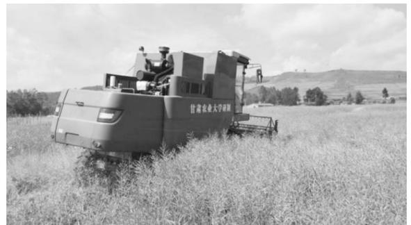
图12 油菜联合收获机田间作业性能试验
