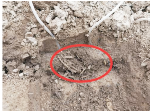
图 7 过水后斜切(45°) 断裂状态
