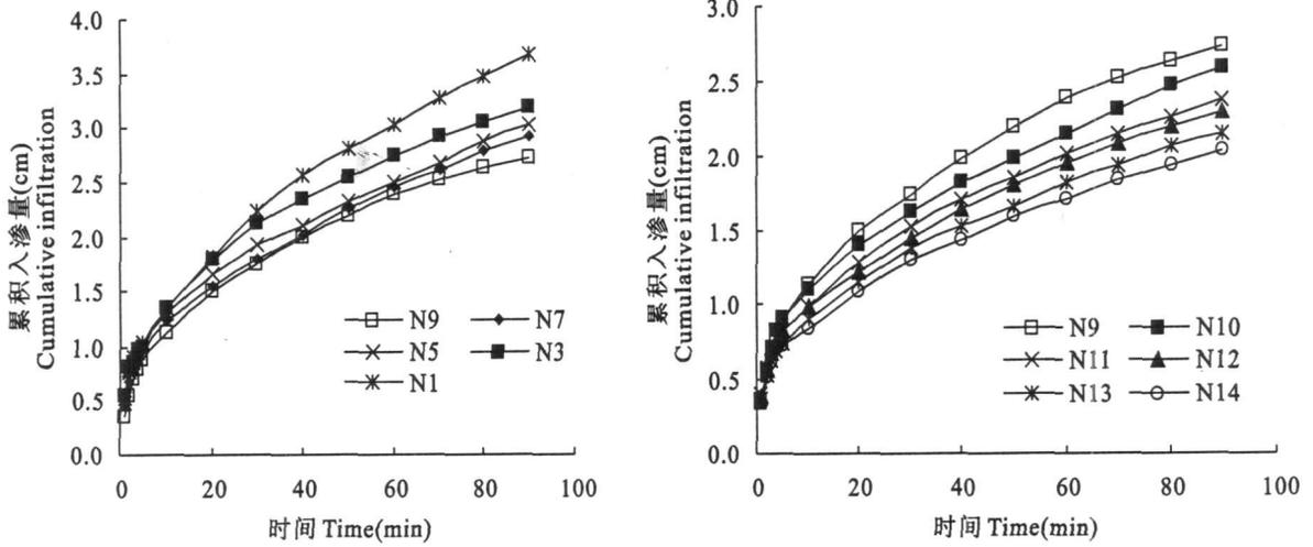
图 4 试验土壤(部分)90 min 入渗累积过程
