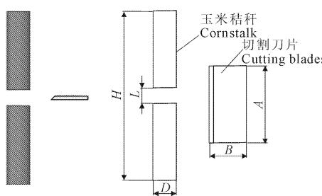
图 1 玉米秸秆—切割刀片模型
