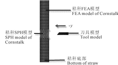
图 2 玉米秸秆—切割刀片有限元模型
