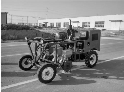
图5 2BZ-4全膜双垄沟精密播种机播种器样机
