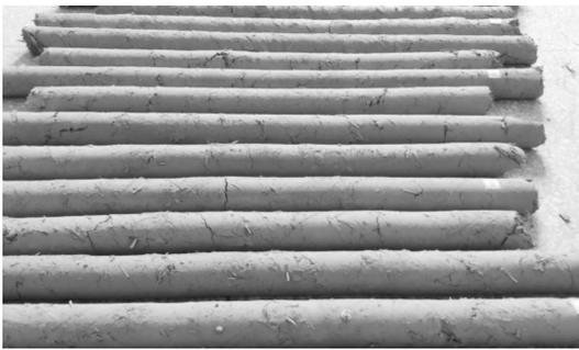
图2 秸秆复合管试样
