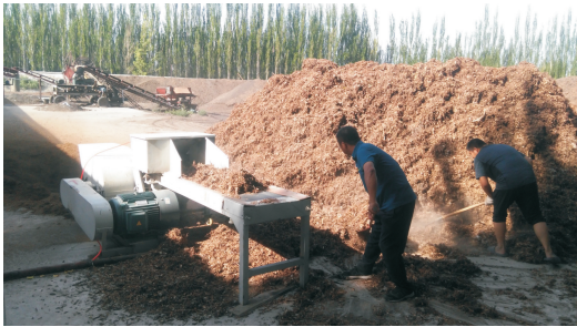
图 16 棉花秸秆无筛粉碎机场地试验
