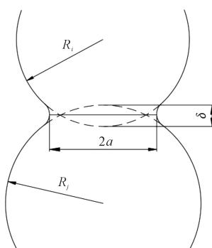
注:  $R_i$ 、 $R_j$  为颗粒半径;  $\delta$  为两颗粒的法向重叠量;  $a$  为接触半径。
