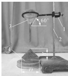
注:  $H$  为茶毫堆积高度 (mm);  $D$  为底盘直径 (mm)。
